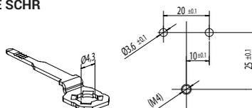
Montáž na hliníkový profil se závitovým kanálem M4 fixace ALP
